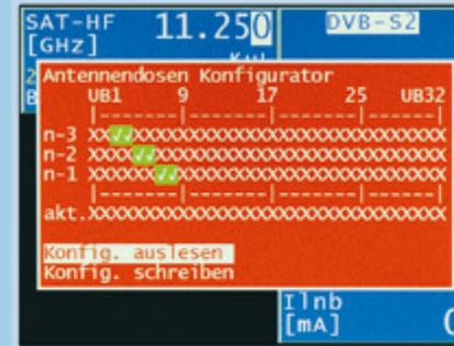
Konfigurationsmenü für programmierbare UNICABLE-/JESS-Antennendosen.
