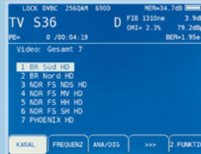
Messung eines optischen BK-Signals mit Auswertung der gewohnten HF-Parameter.
