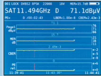
Funktion Datagrabber aktiv bei der Überwachung eines HD-Transponders auf SAT.
