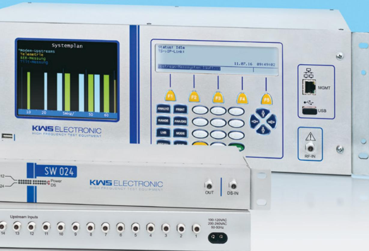
Der zum Kopfstellen-Gerät AMA 310/UMS optional erhältliche HF-Switch SW 024 (19-Zoll, 1 HE) ermöglicht es bis zu 24 Cluster bzw. CMTS-Upstream-Eingänge losgelöst voneinander zu vermessen.
